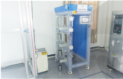
04.电锁耐用测试设备 (意林电插锁50万次耐用测试合格)
