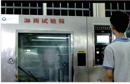
01.防水电插锁雨淋测试设备 (确保产品在户外环境性能的可靠性)
