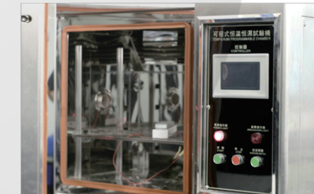
03. 高低温测试 (确保-40°C~60°C恶劣环境应用的可靠性)
